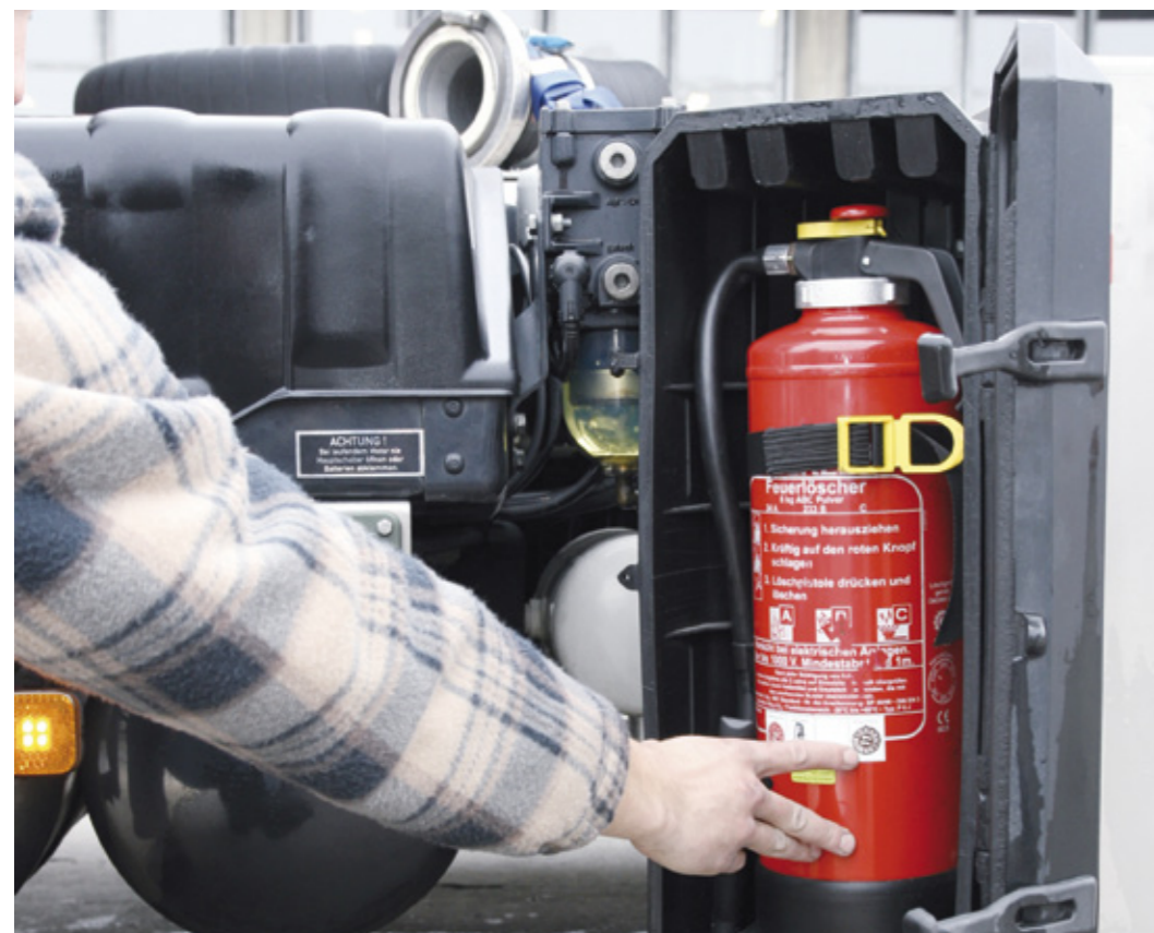
Sicherheitscheck: Die Kontrolle der Feuerlöscher wird den Chauffeuren «eingemipft».
